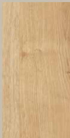
Dąb sękaty (również poprzeczny układ słoików)
